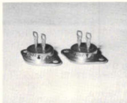
Afb. 15. Twee „half brug” gelijkrichters voor een stroom van 40A.
