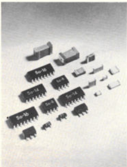
Afb. 7. IC's, transistoren, condensatoren en weerstanden geschikt voor automatische montage.
